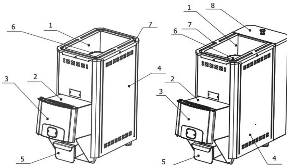
**Рис. 1. Конструкция печи «ТАМАНЬ Т (2017)»
