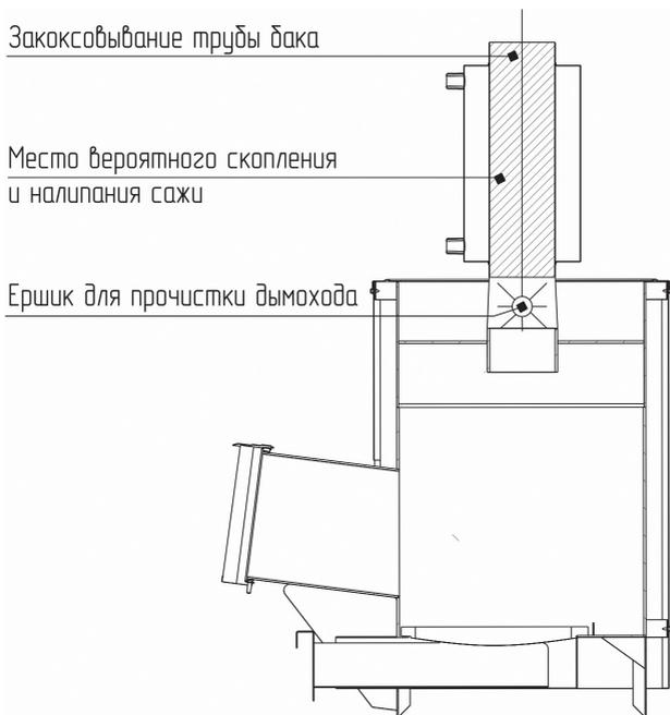
Рис. 6 Схема прочистки печи
